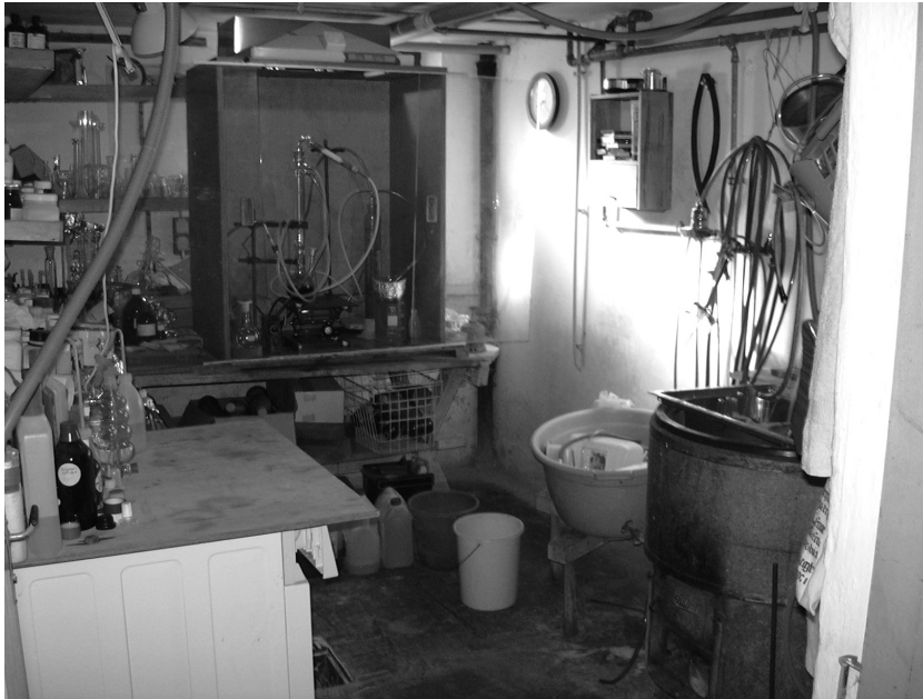
Abb. 1 – Ansicht meines Labors heute: Vorne links besagte Waschmaschine; hinten der Abzug, den mein Vater mit mir gebaut hat; es findet darin gerade ein Friedel-Crafts-Acylierung statt (Synthese von p-Acetylphenyl)
